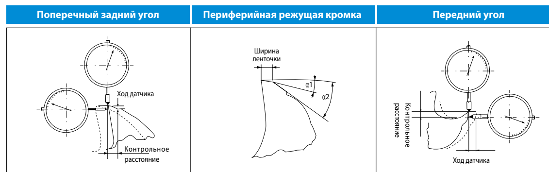
Рис. 6. Установка индикатора для проверки
