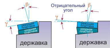
**ДЛЯ ВЫБОРА ОПОРНЫХ ПЛАСТИН С ИЗМЕНЕННЫМИ УГЛАМИ ИСПОЛЬЗУЙТЕ ГРАФИКИ НА СТР. 54**
