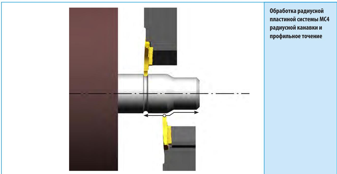
Обработка радиусной пластиной системы M92-Q радиусной канавки и профильное точение
