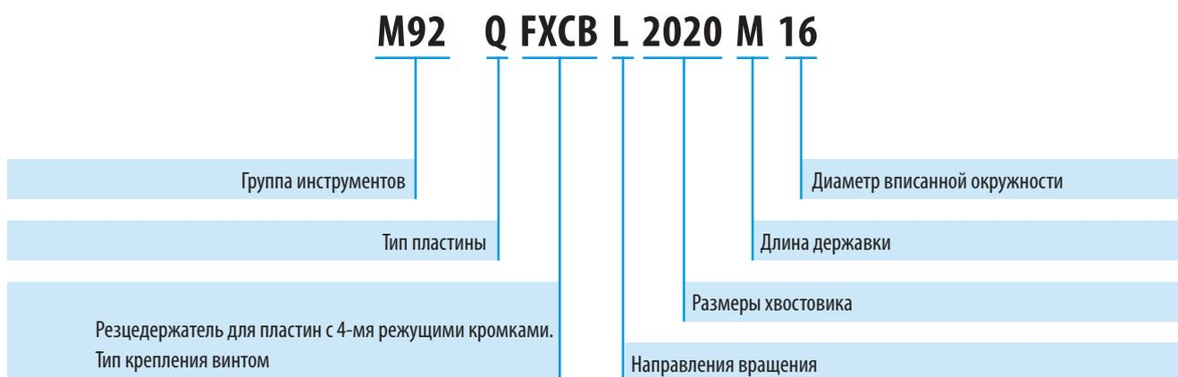
**MULTICUT 4 - Державки для канавочных, резьбовых и копировальных пластин**
