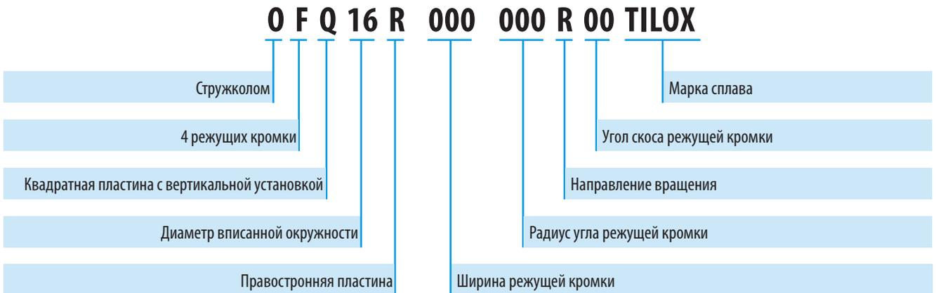
**MULTICUT 4 - Пластины с 4-мя режущими кромками для отрезки и обработки канавок**
