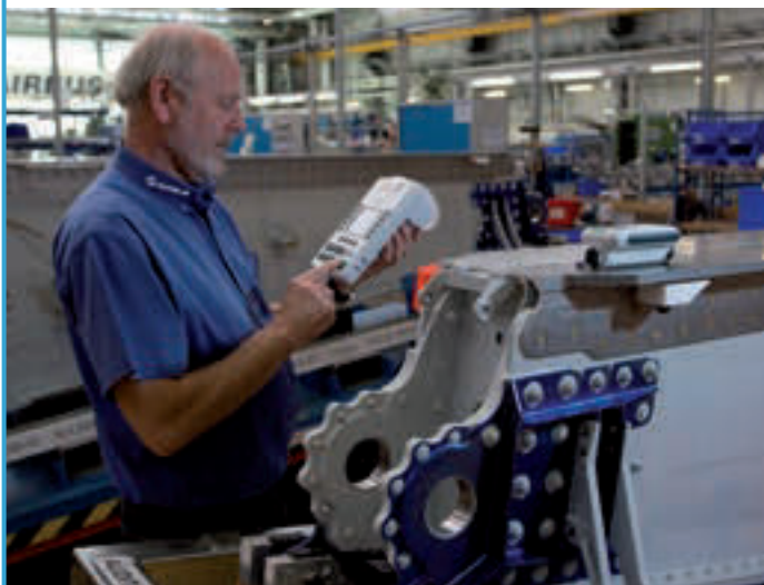
Измерение шероховатости на выдвигающих элементах (предприятие Airbus)
