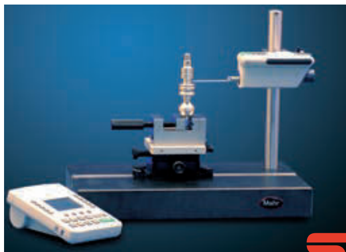
Измерительная установка MarSurf с измерительной стойкой ST-G
