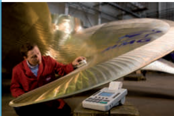
Измерение шероховатости на корабельном винте (предприятие Mecklenburger Metallguss)
