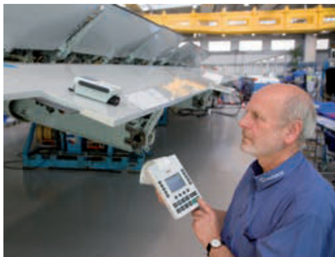
Измерение шероховатости на несущей поверхности (предприятие Airbus)
