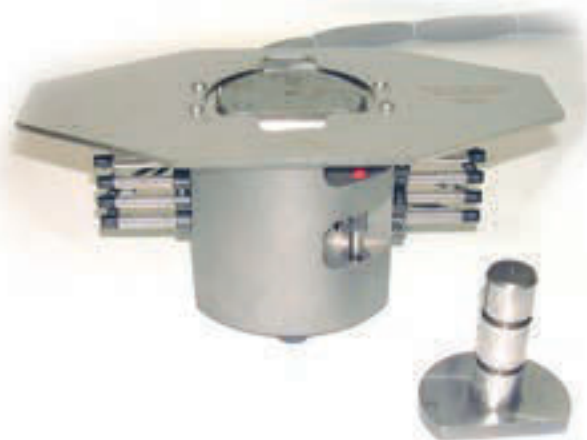
Электронное многопозиционное измерительное устройство для проверки 6 х \phi и прямоугольности
