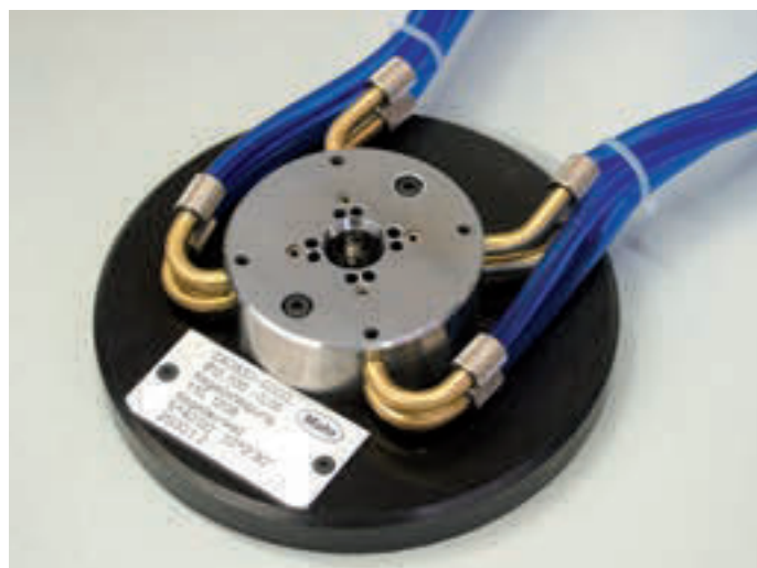
Коническое сопло-измерительное кольцо с парными измерителями в 2-х уровнях для проверки до 4-х \phi , 2-х углов конуса, 2-х уклонов конуса
