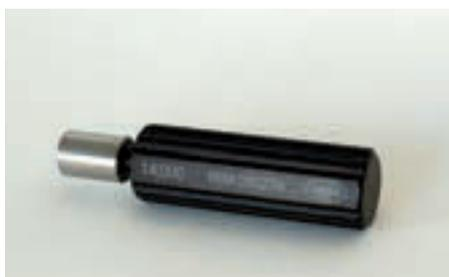
**Millimar 6400 установочные дорны** для сопел-измерительных колец Millimar-установочные дорны тщательно закалены, отшлифованы и отполированы производственный допуск JS3, допуск для цилиндричности 0,1 x числовое значение IT3, Измерительная погрешность отмаркированных фактических размеров 0,5 x числовое значение IT1.
