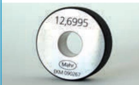
**Millimar 6105 установочное кольцо** для сопел-дорнов и контактных дорнов. Millimar-установочные кольца тщательно закалены, отшлифованы и отполированы. Качество N, производственный допуск JS3, допуск для цилиндричности 0,4 x числовое значение IT4.
