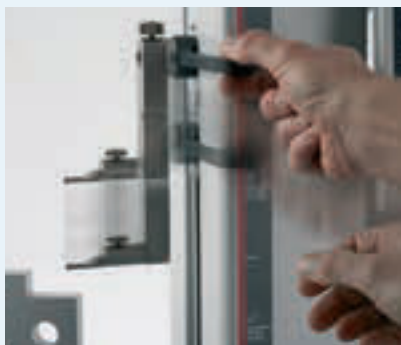
Рис. 1. Переместите измерительную каретку в направлении измеряемого объекта.
