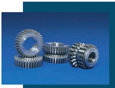
Данные накатники применяются для формирования методом пластической деформации конического сечения на зубьях синхронизирующих колец (замка) для исключения самопроизвольного выключения передачи.
