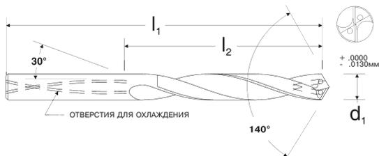
Пример заказа сверла диаметром 6,35 мм с отверстиями для подвода СОЖ. Обработка отверстий глубиной до трех диаметров: НР253 Ф6,35; без отверстий НР243 Ф6,35.
