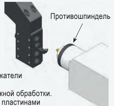
Державки AL...VPGT устанавливаются в держатели осевого инструмента. Применяются для наружной обработки. Комплекуются левыми пластинами VPGT...FL
