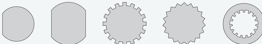
Данный процесс производится при достаточно высоких оборотах шпинделя, в пределах 1500-3000 об/мин. Количество оборотов при данном процессе не влияет на скорость резания. При заходе рекомендуется снижать количество оборотов. При выводе прошивки обороты необходимо снизить или остановить. Подача выбирается в пределах 0,03 - 0,06 мм на оборот в зависимости от обрабатываемого материала и не должна превышать значения полученного по формуле:  $0,03 \times \text{усредненный диаметр профиля}$ .
