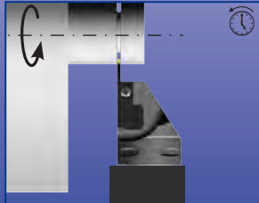
GLM 0° правосторонний базовый держатель + правосторонняя резцовая вставка
