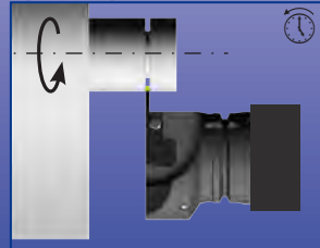
GLM 90° левосторонний базовый держатель + правосторонняя резцовая вставка
