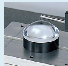
Дополнительно: программное обеспечение ASLPAK для анализа асферических линз
