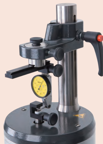
Калибровка рычажно-зубчатых индикаторов с дополнительными принадлежностями
