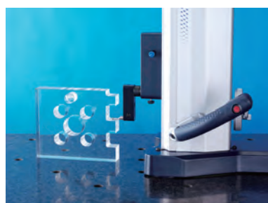
Пример применения QM-Height в плавающей воздушной подвеске
