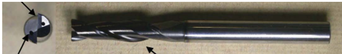
Рис. 2. Фреза фирмы DIJET серии AL-OCHE для обработки алюминия.
