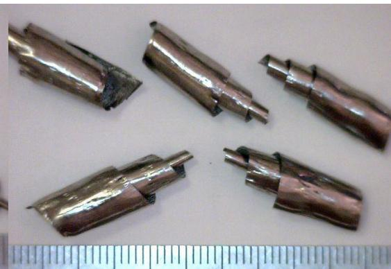
**1) Рекомендуемые режимы резания:** $V_c = 20 \sim 40$  м/мин, $f_z = 0.08 \sim 0.12$  мм/зуб**2) Используйте обильную внутреннюю или внешнюю подачу СОЖ на режущую кромку.****3) Используйте максимально жесткие станки, жестко закрепляйте заготовку и инструмент.**
